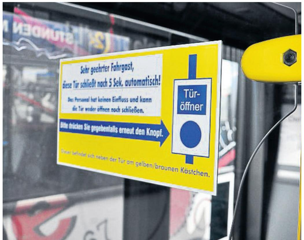
Bei einigen Bussen schließen aufgrund ihrer Bauart die Türen automatisch, wenn kein Fahrgast mehr ein- oder aussteigt. Ein Knopfdruck genügt, um die Türen wieder zu öffnen.
