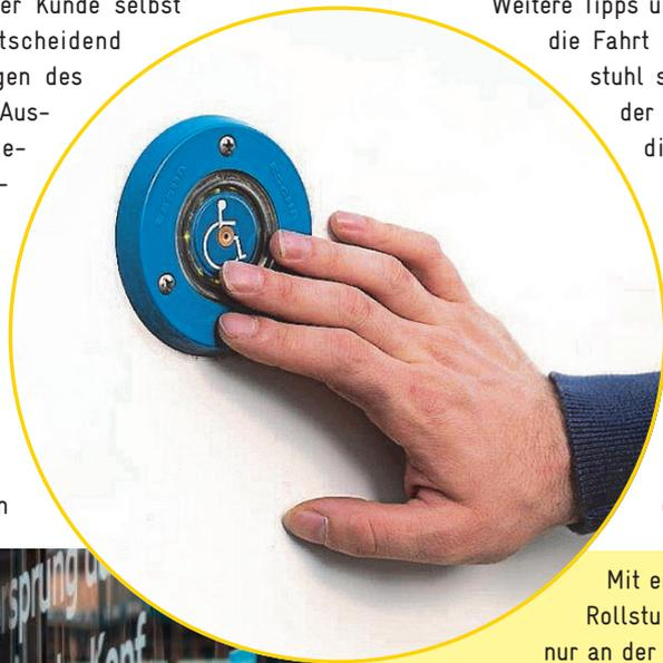
Mit einem Rollator oder Rollstuhl ist der Einstieg nur an der zweiten Tür möglich. Per Signalknopf kann dem Fahrer signalisiert werden, dass die Rampe zum Einsteigen benötigt wird. Foto: oH
