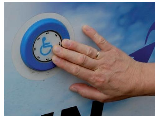
Der Anforderungsknopf ist an der 2. Bustüre angebracht. Er wird gedrückt, wenn die Rampe ausgeklappt werden soll.
