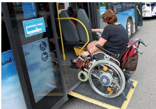
Nur niederflurgerechte Bushaltestellen werden zum Ein- und Ausstieg empfohlen, da ansonsten die Rampe aus sicherheitstechnischen Gründen nicht ausgeklappt werden kann.
